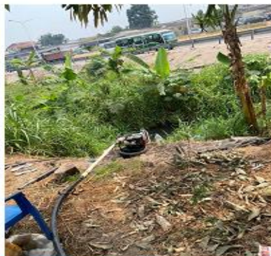
Photos N°2 : illustrant une moto pompe en train de pomper de l'eau
